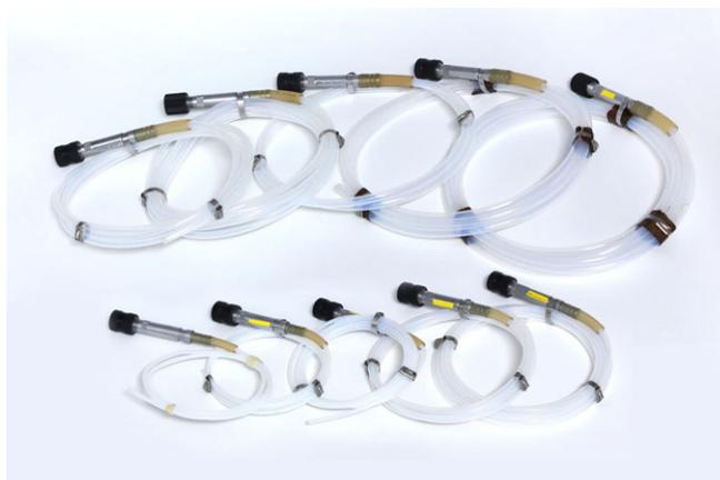
10本テストでは、HPR値が異なる10本のチューブを滅菌し、どのレベルのチューブまで蒸気を浸透させることができるかを試験します。
