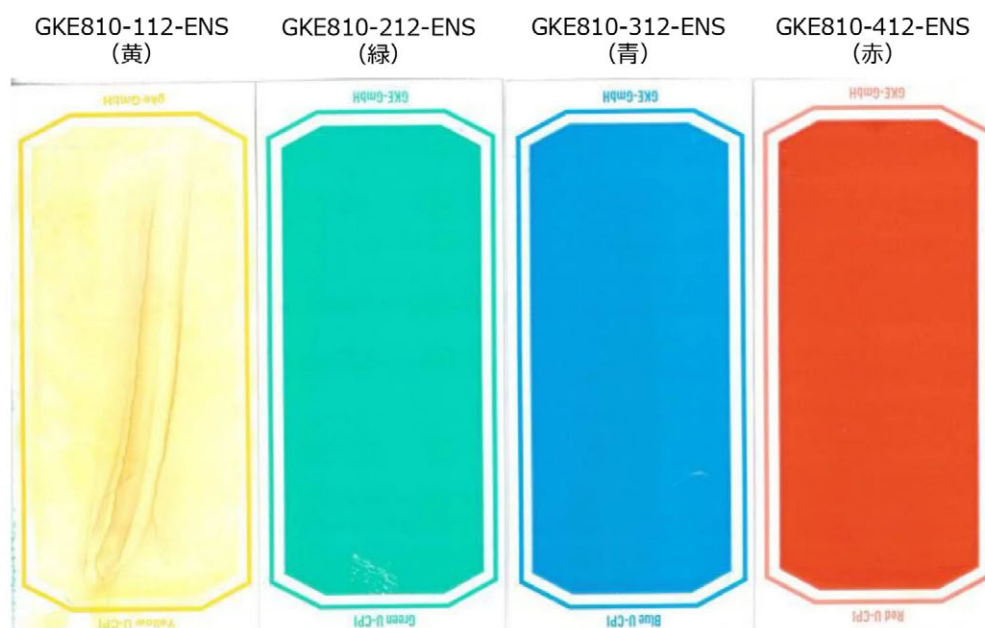
不合格試験（超音波○/洗剤×）のインジケータの色落ち事例
