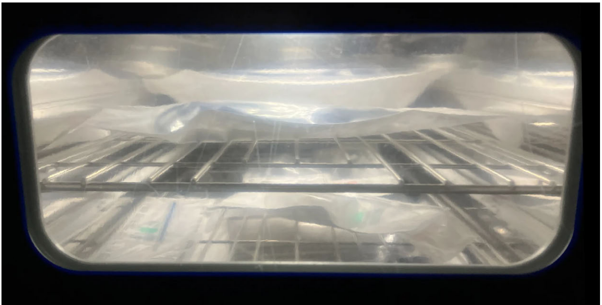
過酸化水素ガス滅菌器で滅菌中の滅菌バッグ
