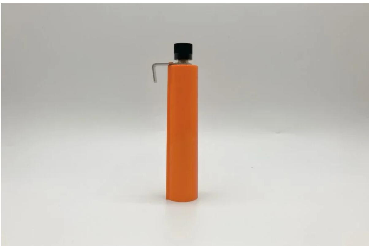
こちらは、SALWAYが実施した検証試験の結果です。SALWAYのコンパクトPCD（ホローロード型）と米国規格AAMIのテストバック原法（ポーラス型）、そして気腹チューブやラパロ鉗子を模した内腔器材の滅菌抵抗性を比較しました。真空パルスの回数と真空引きの深さを調整し、意図的に滅菌条件を悪くした時に、各PCDや器材に挿入したインジケータが不合格を示すかを検証しました。
