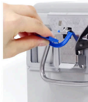
① タブ部分をつまみ、ロックングフラップのふちを支点にしてねじる。
