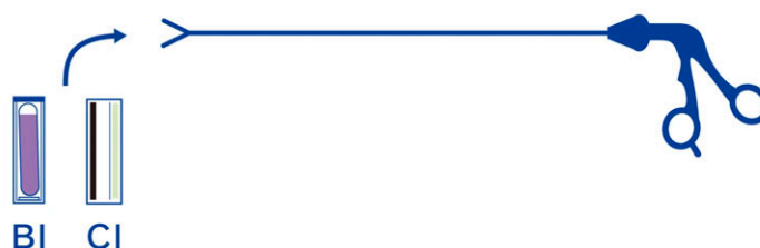
ラパロ鉗子の内腔にインジケータを設置する必要がある
