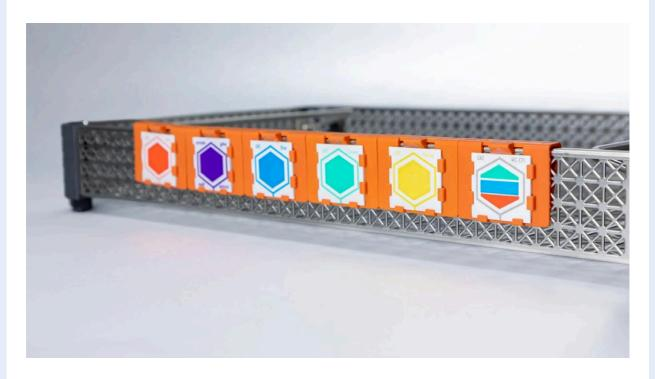
ウォッシャーディスインフェクター(WD)を使用した洗浄工程が正しく行われたかをモニタリングする、洗浄工程インジケータ。
