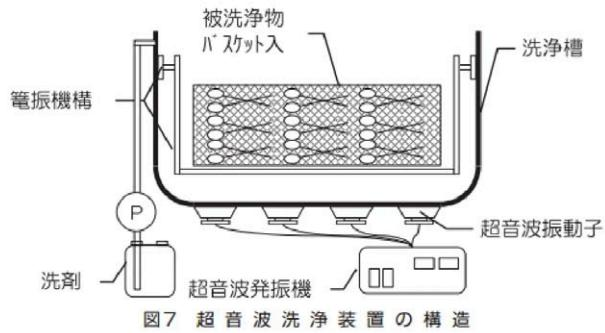
図7 超音波洗浄装置の構造
