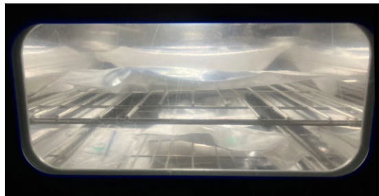
過酸化水素ガス滅菌器で滅菌中の滅菌バッグ
