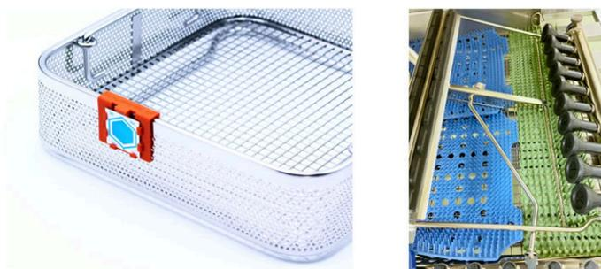
そのため、洗浄ポートに接続して洗浄インジケータを使用できる、専用のホルダーが必要になることがあります。
