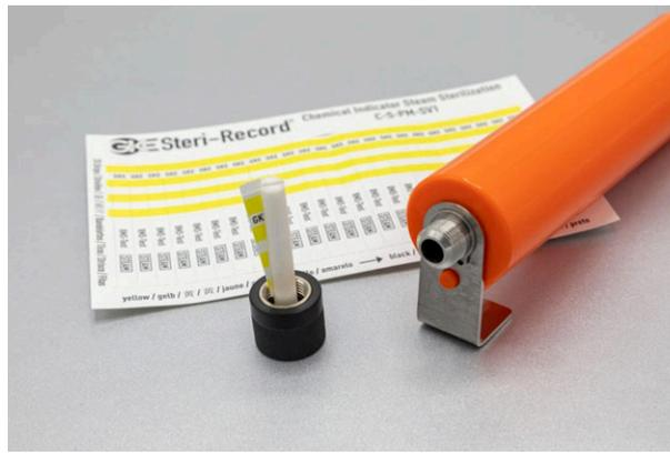
SALWAYのコンパクトPCDは、EN ISO11140-6 Hollow load PCDに適合した、複雑な器材内部レベルでの滅菌条件達成を確認できるPCDです。PCDの内部構造はとても複雑で、ラパロ鉗子などの内腔器材よりも滅菌抵抗性が高く設計されています。
