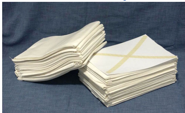
ボウィー・ディックテスト原法（6.6kgコットンパック）
