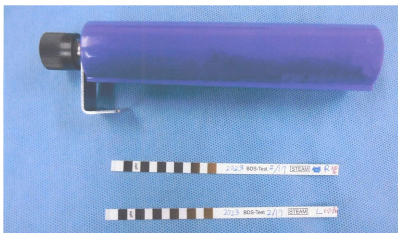
ボウイー・ディックテスト（欧州規格）の試験結果（不合格）
