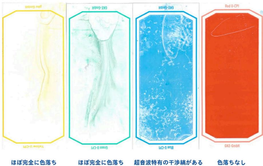
合格試験では、黄色と緑のインジケータがほぼ完全に色落ちし、青のインジケータには超音波特有の干渉縞が確認できました。赤のインジケータは全く色落ちしませんでした。
