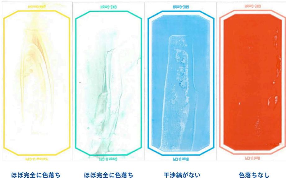
合格試験で超音波洗浄特有の干渉縞を示した青色のインジケータを見ると、この試験では干渉縞がないことがわかります。インジケータを使用することで、超音波によるキャビテーション関連の不具合を検知できることが確認できました。
