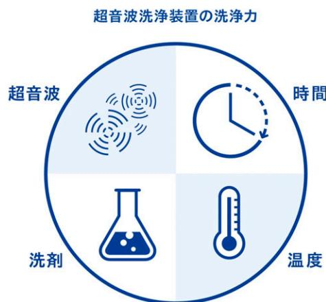
超音波洗浄は、超音波振動子が発する超音波が器材の表面でキャビテーションを起こすことで洗浄効果を示す洗浄方法です。
