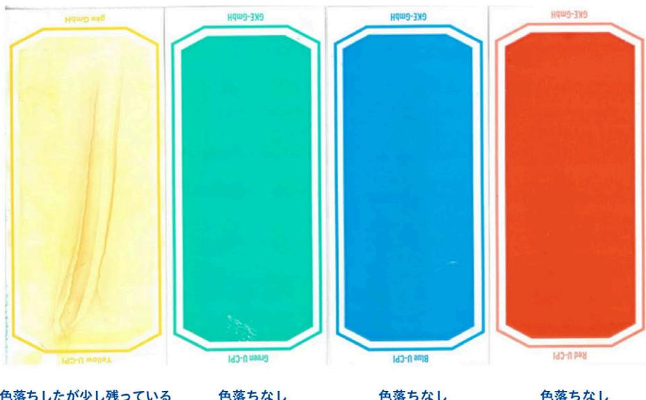
合格試験の色落ちと比較して、黄色以外のインジケータが全く色落ちしていないことがわかります。インジケータの使用により、洗剤関連の不具合を検知できることが確認できました。
