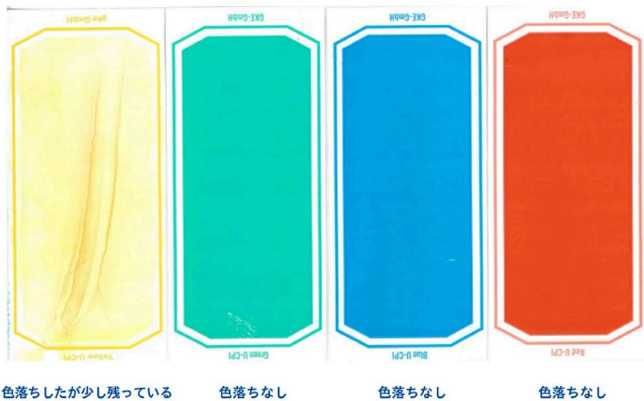
合格試験の色落ちと比較して、黄色以外のインジケータが全く色落ちしていないことがわかります。
