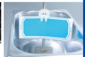
▲ 超音波洗浄用インジケータ
