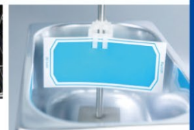
▲ 超音波洗浄用インジケータ
