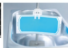
▲ 超音波洗浄用インジケータ
