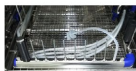
▲ 内腔洗浄の評価に使える フローPCD
