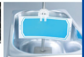
▲ 超音波洗浄用インジケータ
